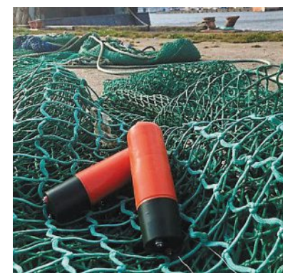
Les pingers, installés dans les chaluts, sont des répulsifs acoustiques destinés à éloigner les dauphins.
